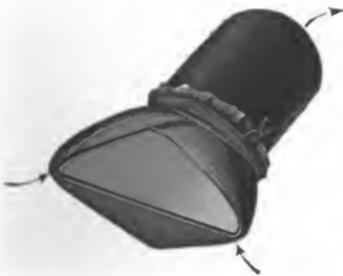
thümlichkeiten studirt man am besten an künstlich verfertigten Zungen dieser Art. Zu dem Ende schneidet man das obere Ende eines hölzernen oder Guttapercharohres von zwei Seiten her schräg so ab, wie Fig. 30 zeigt, dass zwei etwa rechtwinkelige Spitzen zwischen den beiden schrägen Schnittflächen stehen bleiben. Dann legt
