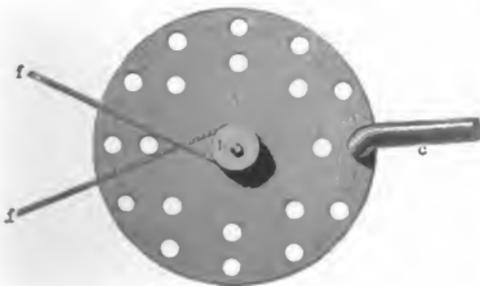
Schnur *ff* schnell gedreht werden kann. Längs des Randes der Scheibe ist eine Reihe von Löchern in gleichen Abständen von einander angebracht, in der Zeichnung 12; eine oder mehrere andere Reihen gleichabstehender Löcher befinden sich auf anderen
